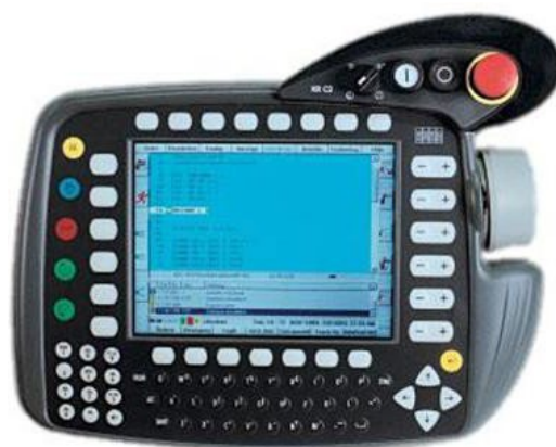
Slika 19: Naprava za programiranje snemanja gibanja (Teach Box KR C2)
